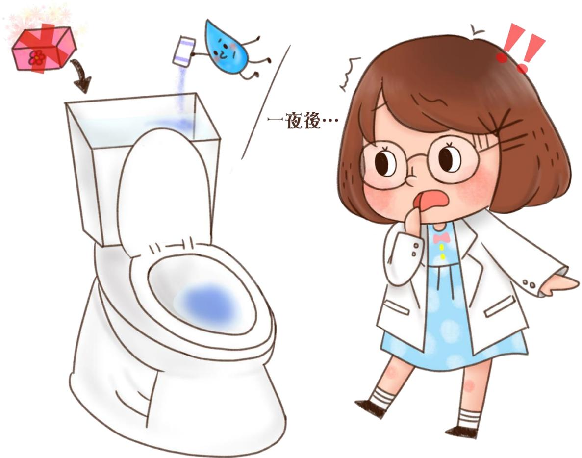
(3)可將馬桶水箱進水三角閥關閉後，使用馬桶水箱測漏試劑，靜置一夜後觀察馬桶內的水是否因試劑變色，若變色則代表漏水，沒變則代表沒有漏水。亦可透過觀察水箱水位是否下降來判斷是否漏水，若有漏水需更換水箱止水閥。
